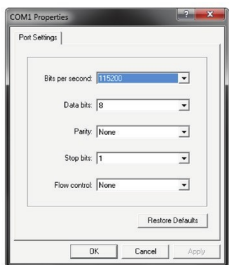
Рисунок 10. Свойства соединения в программе Hyperterminal
