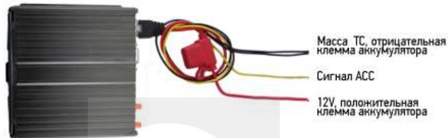
*Примечание: при тестировании устройства, подключите оба провода – красный и желтый провод с положительным полюсом источника бесперебойного питания, в противном случае устройство не загрузится.*
