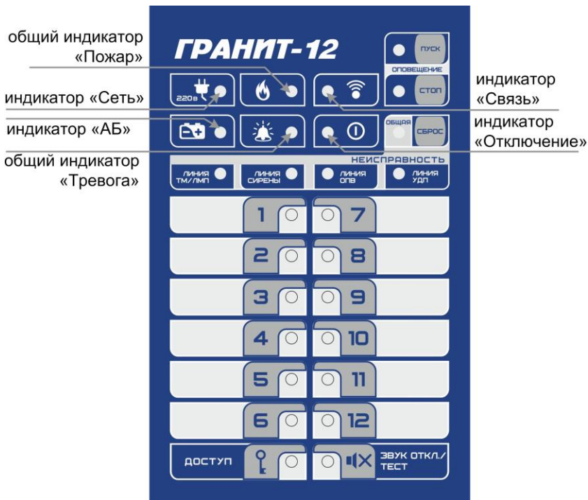
Рис.2 Панель индикации и управления прибора Гранит-12А GSM
