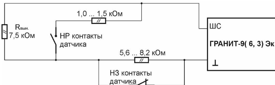
Рис.6. Схема включения технологических датчиков в ШСТ.
