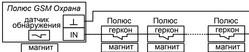
Рис.6а Схема подключения внешних датчиков. Значение «2» параметра №37
