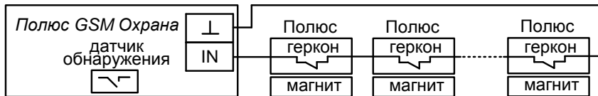
Рис.6б Схема подключения внешних датчиков. Значение «1» параметра №37, вариант 1
