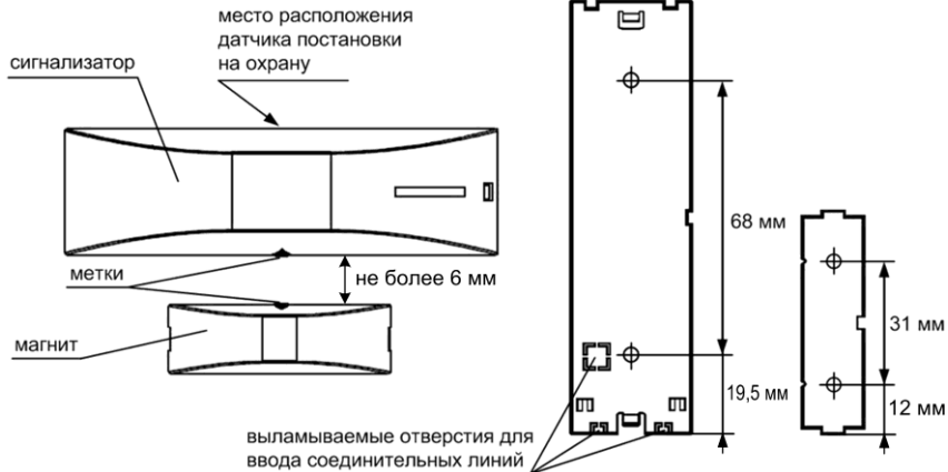
Рис.9 Схема установки, установочные и присоединительные размеры
