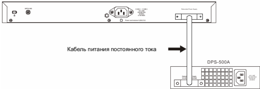
Рисунок 10 — Подключение DPS-500A к коммутатору
