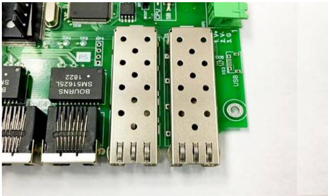
Рисунок 8. Порты SFP Коммутатора
