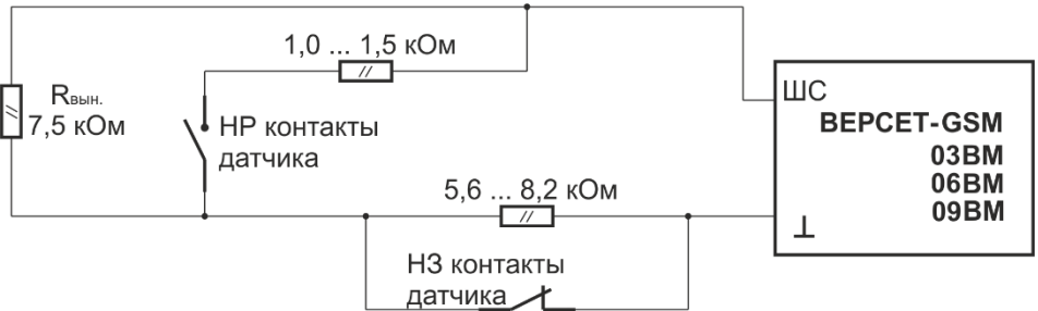
Рис.7. Схема включения технологических датчиков в ШСТ.
